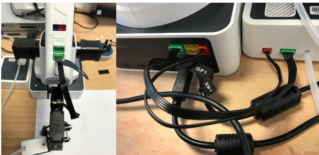
Figure 22 : Connexion de la pince et du mini-compresseur au robot.
